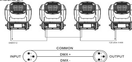
Cada efecto luminoso en la cadena necesita disponer de su propia dirección de inicio de forma que sepa qué comando del controlador debe descodificar.
